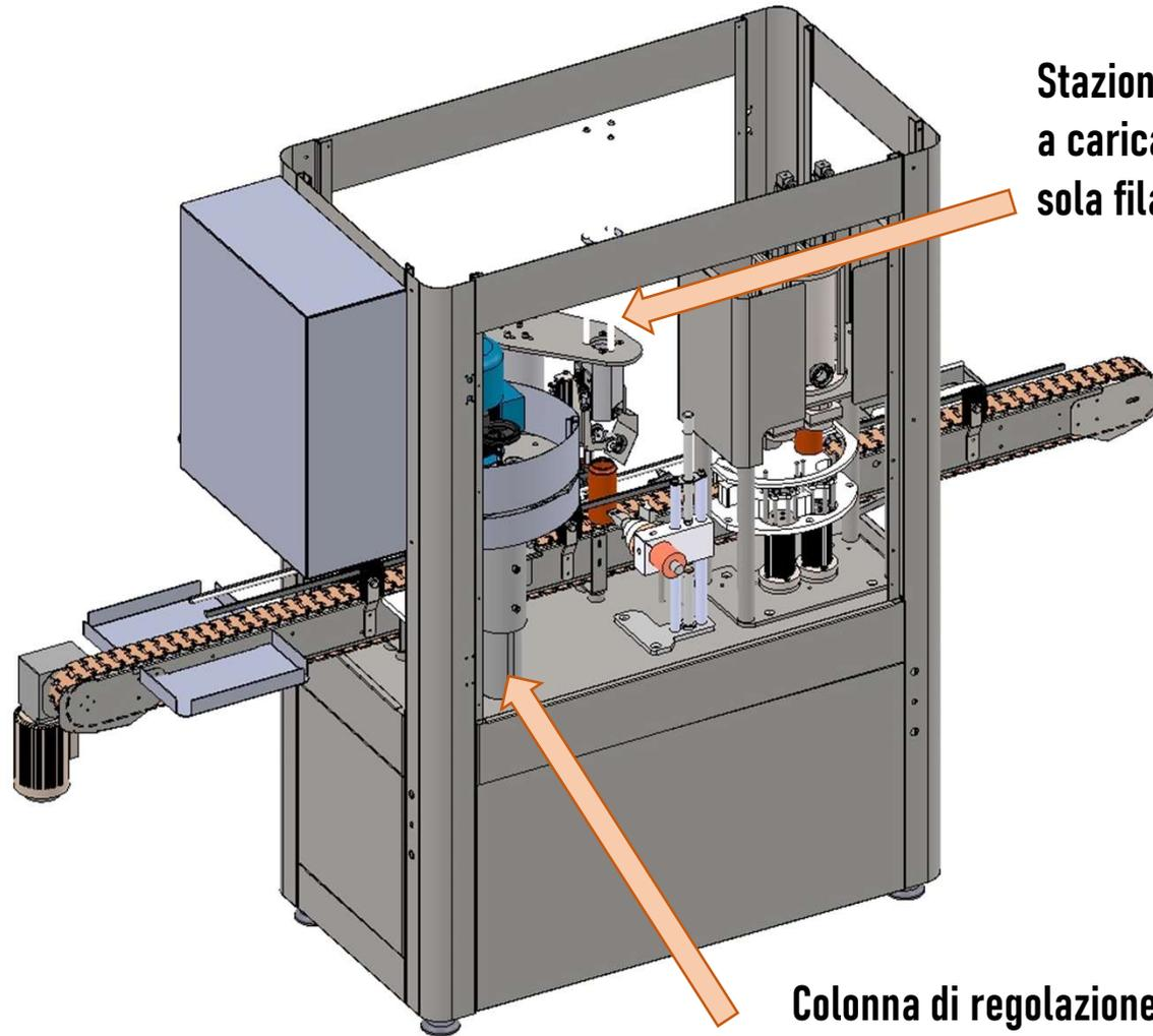
**Stazione di distribuzione coperchi a caricamento diretto, consentita una sola fila di coperchi per volta**
